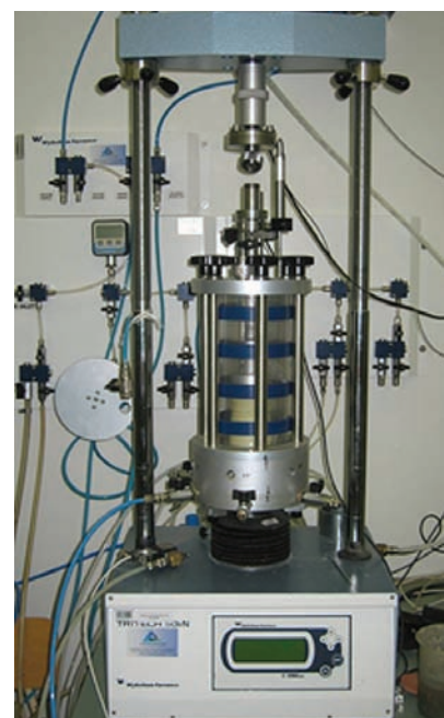
7. ábra. Ciklikus triaxiális berendezés (Széchenyi István Egyetem, Geotechnikai Laboratórium)
